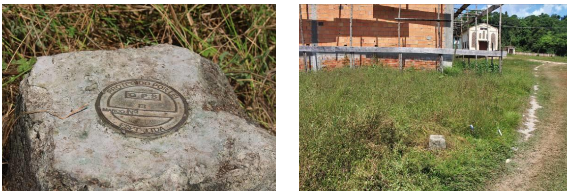
Figura 21- Marco topográfico usado para indicar o traçado da futura Ferrovia Paraense (Fepasa), ao lado do centro comunitário da Comunidade Nazaré do Alto, Acará, 2019
